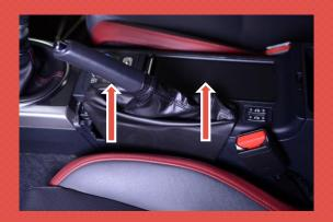
2. SLIDE THE SHIFT BOOT OVER THE EMERGENCY BRAKE HANDLE.
