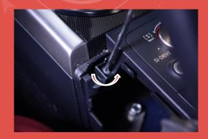
4. PULL THE CENTER CONSOLE STAIGHT BACK, SLIDING IT OFF THE LOCKING PUSH CLIP.
