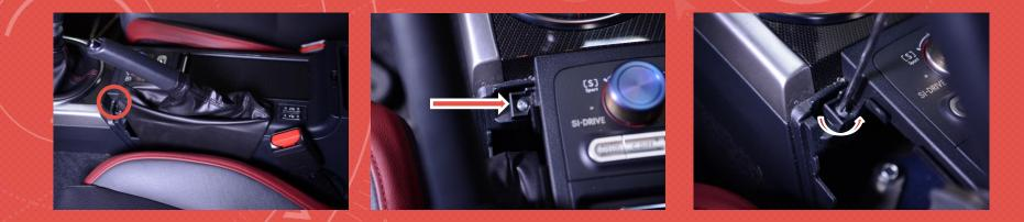
4. PULL THE CENTER CONSOLE STAIGHT BACK, SLIDING IT OFF THE LOCKING PUSH CLIP. \*NOTE: TAKING OFF THE E-BRAKE BOOT IS NOT REQUIRED.
