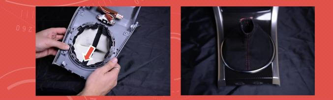
15. FROM HERE SIMPLY WORK BACKWARDS FROM STEP 9 TO COMPLETE THE INSTALL. BE SURE TO GENLTY SLIDE THE BOOT OVER THE REVERSE LOCKOUT ON 6SPD MODEL CARS TO AVOID DAMAGE TO THE BOOT
