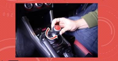
7. CAREFULLY PULL TOWARDS THE BACK OF THE CAR ON THE TOP OF THE SHIFTER SURROUND. MAKE SURE TO PULL EVENLY ON BOTH SIDES AND CLOSE TO THE TOP AS POSSIBLE. THIS IS NOT TO DAMAGE THE CLIPS ON THE BACK SIDE. THEY WILL "POP" ONCE THEY COME UN-DONE
