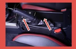
3. UNDER THE BRAKE BOOT, TOWARDS THE FRONT OF THE CAR REMOVER THE HEX SCREW
