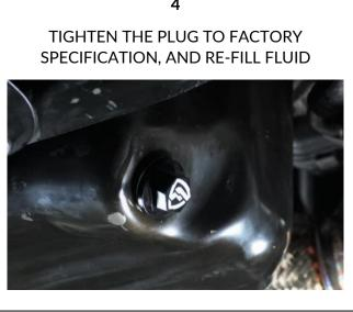
NOTE: M18x1.5-12 DRAIN PLUGS DO NOT INCLUDE A GASKET. A FACTORY DRAIN PLUG GASKET NEEDS TO BE TRANSFERRED FROM THE REMOVED PLUG AND RE-USED ON THE NEW PLUG
