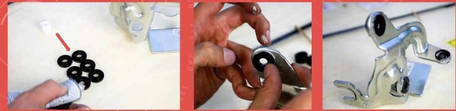
8. REPEAT STEP 5 THROUGH 1 BACKWARDS TO RE-INSTALL THE BRACKET. <u>TORQUE THE BRACKET DOWN TO</u> <u>15FT-LBS</u>
