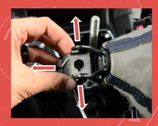
3.2 (RS). TAKING A HEAT GUN, GENTLY WARM UP THE PLASTIC TRIM TO MAKE IT MALLEABLE AND PREVENT BREAKING. DO NOT OVERHEAT AS PLASTIC CAN BE EASILY DAMAGED. TAKE TWO SMALL FLAT HEAD SCREW DRIVERS AND PLACE THEM INSIDE THE CUP TO PRY THE FINGERS AWAY FROM THE CENTER WHILE PUSHING DOWN ON THE SILVER CENTER.
