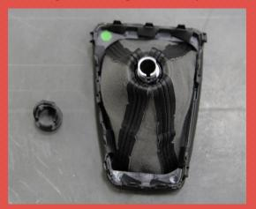
3.1 (RS). TURN THE BOOT INSIDE OUT. REMOVE THE REVERSE LOCKOUT BRACKET BY TURNING IT 90 DEGREES AND SPREADING THE EARS.
