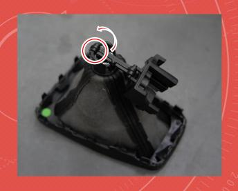
3.2 (ST). TAKING A HEAT GUN, <u>GENTLY</u> WARM UP THE BLACK PLASTIC TRIM TO MAKE IT MALLEABLE AND PREVENT BREAKING. DO NOT OVERHEAT AS PLASTIC CAN BE EASILY DAMAGED. TAKE TWO SMALL FLAT HEAD SCREW DRIVERS AND PRY THE EARS OUTWARD WHILE PUSHING DOWN ON THE SILVER CENTER.
