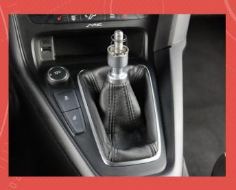
2. USING YOUR HAND, PULL UP ON THE BACK SIDE OF THE SHIFT BOOT TRIM UP-WARD. ONCE THE BACK POPS UP, WORK YOUR WAY AROUD THE TRIM. AND REMOVE FROM VEHICLE
