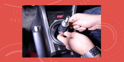
9. FLIP OVER THE SHIFT TRIM SURROUND AND UNCLIP THE WIRING HARNESS BY PUSHING ON THE CENTER TAB AND PULLING THE CHASSIS SIDE OF THE HARNESS AWAY FROM THE TRIM.
