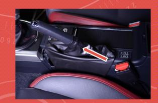
3. BEGIN REMOVING THE FACTORY BOOT FROM THE PLASTIC CAGE.
